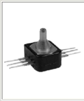
最新经济型 40PC 产品是由 Honeywell/MicroSwitch 分部推出的最小体积放大压力传感器。完全校整和温度补偿，是霍尼韦尔压力产品中最坚固、适用温度最宽的传感器。另外，40PC 可与很大范围的介质兼容，从干燥空气和水到冷却液和机油。40PC 提供模拟放大信号输出，传感器利用了独创的单硅片的设计，把所有温度补偿、输出零点、满量程校整、放大功能集中在一块硅片中。
