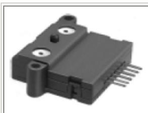
AWM40000 系列放大输出气体质量流量传感器, 多个集中安装 / 0 形密封圈, 陶瓷流量管 (无引气管), 0-1000scm, 塑料流量管 (无引气管), 0-6SLPM, 高共模压力 (150psi), 工作温度可至 125℃, 零点和满量程高稳定性
