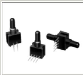
专利的导电密封弹性连接系统消除了传统的导线粘结和带状连接，增加了介质的测量兼容性，专利的结构导致了多样化的测量孔形式，最低价格的带温度补偿和校整的小型封装压力传感器，不同的引脚可选（1X4 或 2X2），可以测量负压、正压，激光刻蚀电阻保证极好的器件一致性
