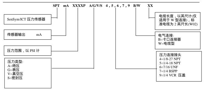
例如: 部件号 **SPTmA0100PA4W02**=SPT mA 传感器, 100psi, 绝压, 1/8 NPT 压力孔,配有 2 英尺长的电缆(引出端)用于电气连接。
