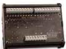
此串口 - 并口转换器将SSI 或 RS-422 的串行数据转换为 15 位并行输出，从而实现使用简单的、低成本双绞电缆来取代使用高成本、噪音敏感、长距离并行电缆，实现与带并行输入接口的 PLC 或控制器的通讯。串行输入类型可根据时钟速度（对 SSI）或波特率（对 RS422）进行选择，输出类型可以为输出等于输入，输出恒定 5V 或输出等于集电极开路。
