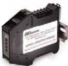
此模块是增量编码器与接收电路之间的通用接口。接受单端或差分输入，并通过开路集电极或长线驱动方式进行单端或差分输出。
