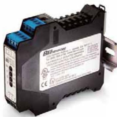
此款电位隔离电气模块是 BEI Sensors 的本质安全编码器的完美补充。通过搭配我们的电缆组件，它们可以完全适用于 1 类和 2 类 1 区危险环境。本质安全栅针对拥有不同正交输出和单个索引的增量编码器提供隔离的电源与信号，这种一体式方案节约了成本，也免除了其他系统要求必须要购买分开的电源和信号栅所造成的不便。此安全栅具备电气隔离，节省了维护完整接地所需成本。通过不同线驱动输出，此安全栅能以 250kHz 的带宽传输数据达 500 英尺。
