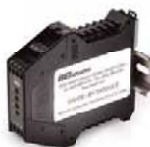
此模块接受单端或差分输入，然后将信号按工厂设置值（2 至 256）进行分频。分频后的输出信号相对输入信号而言，分辨率降低了。常用于机器改装以及其他需要与同一编码器输出信号不同分辨率的应用。下单时，请在型号中指定分频数。
