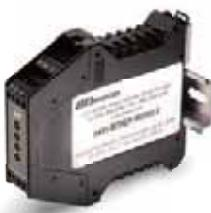
当应用中因为停止 / 启动循环或振动环境并且没有使用正交信号来提供方向检测功能从而引起位置错误时，此模块将扮演关键角色。可接受 A 信号和 B 信号，并
