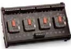
此编码器信号广播器接受标准增量编码器输入（正交的两个通道加一个零位和补充），能为四个独立设备广播多达四个编码器信号。每个广播信号都经过光学隔离。紧凑封装也适用于信号处理，例如防抖过滤器，集成分频或脉冲、方向输出，可与四个广播信号中任意一个合并。广播器可用于需要用单个编码器来驱动多个接收器的应用场合，比如电轴或多设备的单动作同步。
