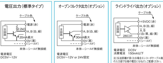
0VとFG(フレームグランド)の間にコンデンサ(0.1μF)が接続されております。
