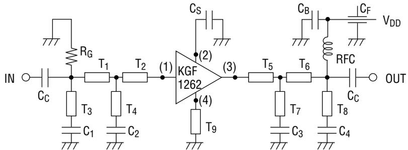
$T_1$ :  $Z_0 = 75 \Omega$ ,  $E = 90 \text{ deg}$        $T_5$ :  $Z_0 = 75 \Omega$ ,  $E = 70 \text{ deg}$
