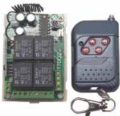
**学习对码方法:** 一直按住学习按键大约 3 秒钟后,学习指示灯变亮,松开按键,然后按无线遥控器中的按键发射信号,这时指示灯变灭,既表示学习进去了.在此间没有任何操作,5 秒后 LED 熄灭自动退出学习状态.再次学习的时候重新按照以上的操作即可.
