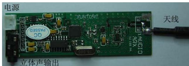
NX107PA 是加强功率型无线麦克风模块 (最大发射功率+20dBm), 包括:
