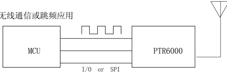
应用之二：可完成点对点传输的数据采集，用于工业控制，数据采集，无线键盘，身份识别、无线标签等。
