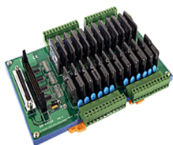
DB-24SSR 24 通道固态继电器输出板
