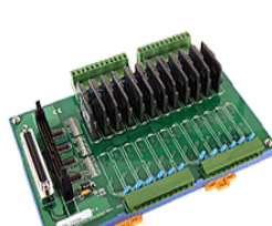
DB-12SSR 12 通道固态继电器输出板
