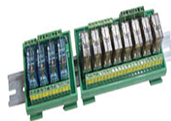
RM-104/108/116 泓格 RM 系列带导轨的功率继电器模块
