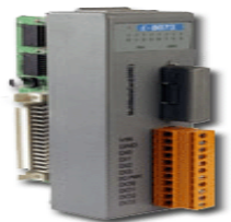
DB-889D 16 通道模拟量多路传输器板
