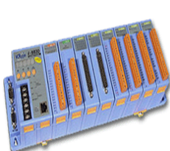
I-8431-MTCP-G/I-8831-MTCP-G Modbus/TCP 嵌入式控制器
