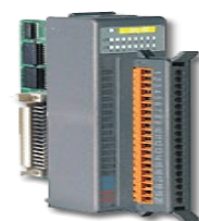
I-8056-G 16 通道非隔离集电极开路输出模块
