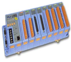
I-8431-80-MTCP-G/I-8831-80-MTCP-G Modbus/TCP 嵌入式控制器
