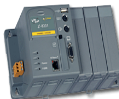
L-8331-G Linux 可编程自动化控制器
