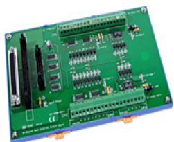
DB-24C 24 通道集电极开路输出板
