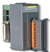
I-8058-G 8 通道带隔离数字输入模块
