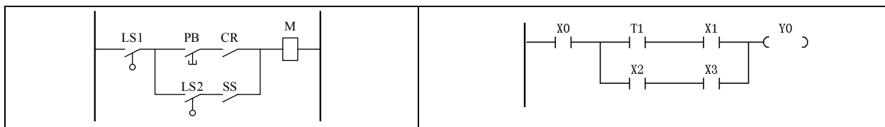
图4-1 电气控制图和梯形图的等效关系
