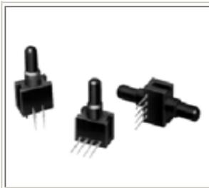
专利的导电密封弹性连接系统消除了传统的导线粘和带状连接,增加了介质的测量兼容性,专利的结构导致了多样化的测量孔形式,最低价格的带温度补偿和校整的小型封装压力传感器,不同的引脚可选(1X4 或 2X2),可以测量负压、正压,激光刻蚀电阻保证极好的器件一致性
