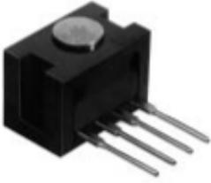
FS系列触力传感器能够在小型商用级别封装下提供精确、可靠的触力传感功能，传感器内含已技术成熟的经特殊微切削硅传感芯片，低功耗、无放大、无补偿的惠斯顿电桥设计在 1500g 量程中输出恒定的 mV 信号。
