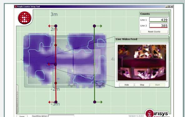
行动图谱’功能同样适用于IRC3030‘双视图’计（人）数器，从而提供‘行动图谱’和视频流的强大合并功能。上图展示了‘行动图谱’被显示在‘双视图’屏幕上的情况。如图所示，左侧部分是‘行动图谱’，右侧则是实况视频。这两种工具组成了功能全面的安装和设置工具套装。这种不懈可击的组合保证了一次到位的安装，大幅度的减少重复性的现场视察和往返的故障探测任务。
