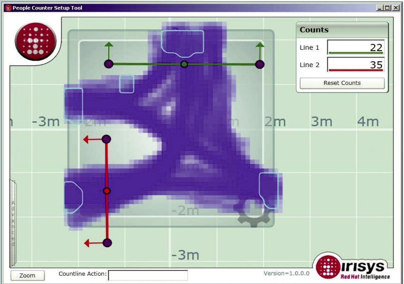
此图片展示了计（人）数器在‘行动图谱’功能启动状态下的工作视图。一旦启动，‘行动图谱’就随时间而逐步构建，同时蓝色的行动图谱则覆盖在计（人）数器的视图区域上。简而言之，行动路径的蓝色愈深，则意味着愈多的人通过此区域。
