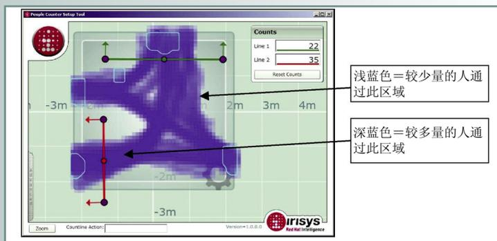
在‘行动图谱’上显而易见的另一个产品特性是：计数区域的边沿所出现的浅蓝色区域，其代表着‘初始化’情况的出现。初始化情况是指当一个人（移动物体）首次进入被观察区域时，计数器成功探测到此人（移动物体）所需要的相应的时间（空间）。移动个体必须被计数器正确的识别（初始化）后，才可以被正确计数。这意味着计数线不应该被安置在初始化区域，原因在于初始化状态下的计数是不正确的。
