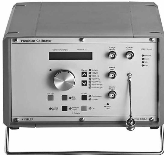
Komfortable, drehgeschwindigkeitsabhängige Einstellung der Ausgangsladung bzw. -spannung mittels Drehknopf; Anzeige des Wertes in pC bzw. Volt. Elektronische Blockierung des Einstellwertes mit der Taste "Dial Lock".
