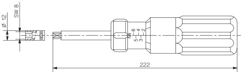
Bild 4: Drehmomentschlüssel 1 ... 6 N-m Typ 1300A17
