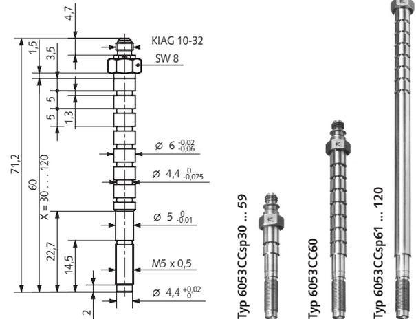
Bei hohen Drehzahlen (Vibrationen) soll der Typ 6053CC...U40 verwendet werden. Bei überwiegendem Einsatz im Klopfbetrieb oder bei sehr hohen Spitzendrücken wird der Einsatz des Typ 6053CC...U20 mit verstärkter Membrane (Heavy-Duty-Version) empfohlen.
