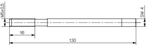
Bild 4: Spezial-Gewindeschneider Typ 1357A
