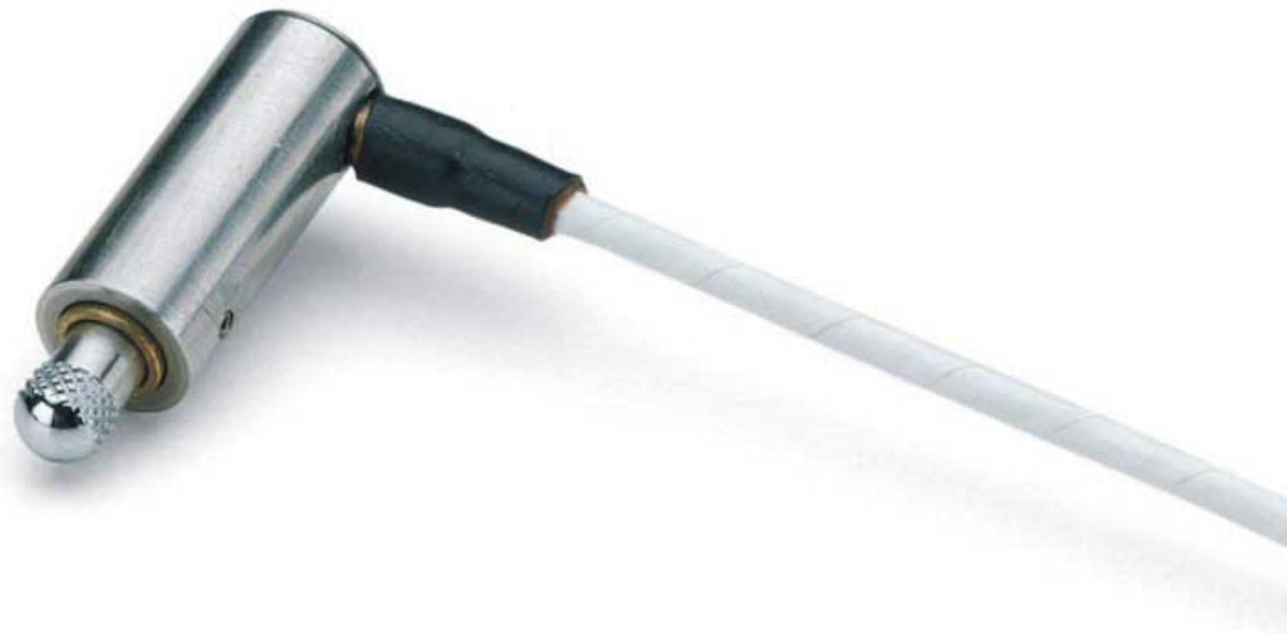
超小型测量头可为空间受限的应用提供精确的测量。由于设计有径向电缆引出端，因此该测量头可以极其方便地与小型固定夹具和较小的内径相配合。此型测量头采用交流供电，与 Schaevitz® 信号调节器相兼容（请参见第 105 页本产品目录的“LVDT 检测仪器”部分）。
