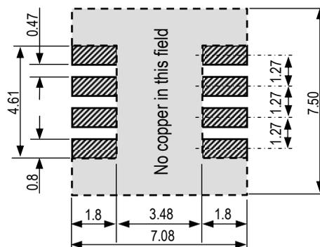
图7: 推荐 SHT1x 引脚尺寸. 单位 mm.
