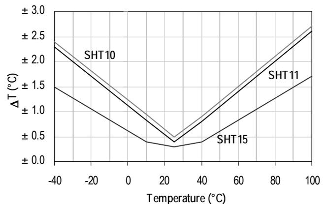
图 3: 每种型号传感器的温度最大误差
