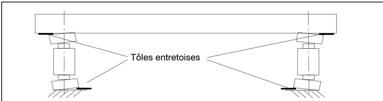
Cet effet peut être annihilé par une construction spéciale, par laquelle les points d'appui sur le pont-bascule sont remontés aussi loin que possible, en direction de la fibre à flexion neutre.
