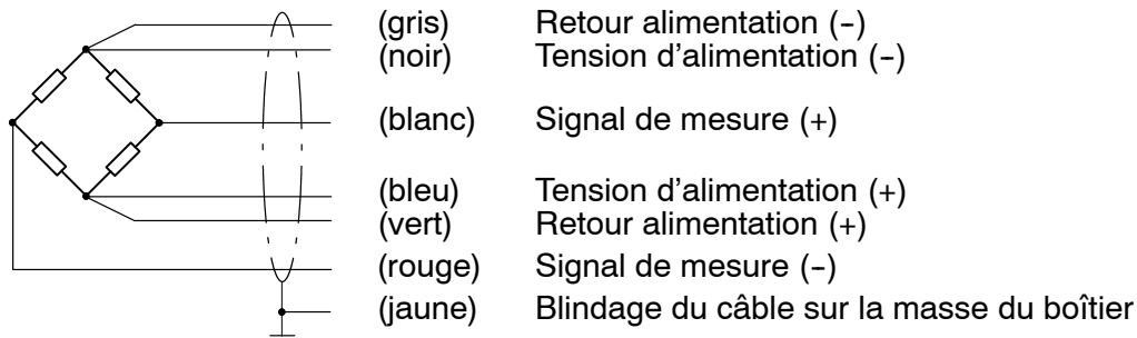
Des champs électriques et magnétiques sont souvent la cause de tensions parasites sur les circuits de mesure. Pour cette raison, veiller :
