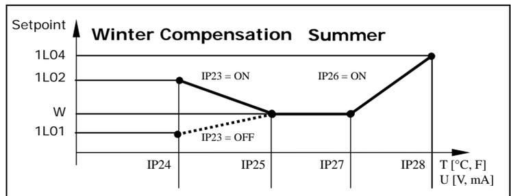
**夏-冬补偿**: 改变控制回路的设定点的最低点 (反移) 或最高值 (正移) 靠外部信号的补偿。这里采用的是外部温度作为温度补偿。冬季当外界温度补偿低于冬季补偿，补偿温度达到最大值的下限，实际监测点会在这种情况下等于最低限额设定点为转变点或反移的最高限额设定点为转变点。夏天当外界温度补偿低于冬季补偿超出下限夏季补偿。当温度达到最高上限为最大值。
